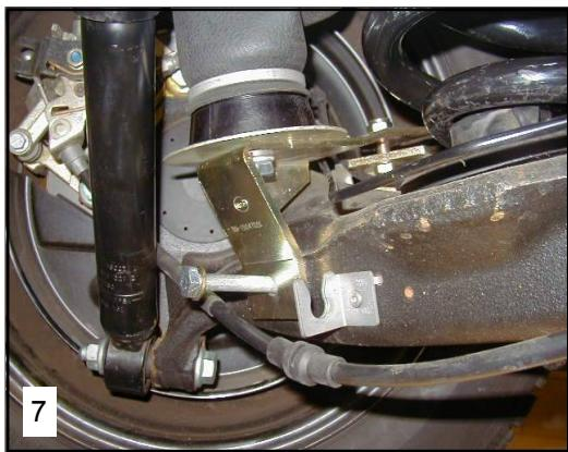
**NL** Verwijder de rubber stop uit de voorzijde van de draagarm en montere de onderbeugel in de ovale gaten van de draagarm. Plaats de lange bout door de onderbeugel.
