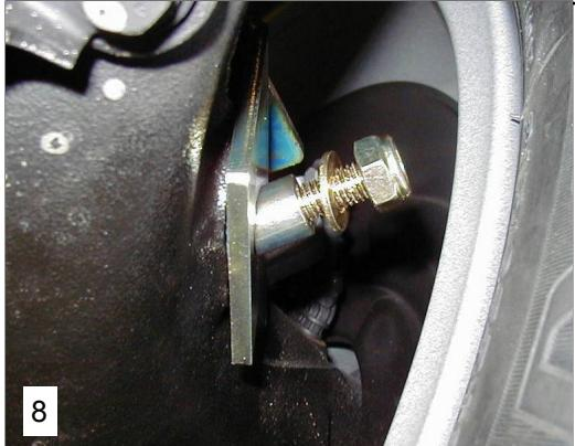
**NL** Plaats de schuine vulring over de bout en zet de moer vast met **40 NM**.
