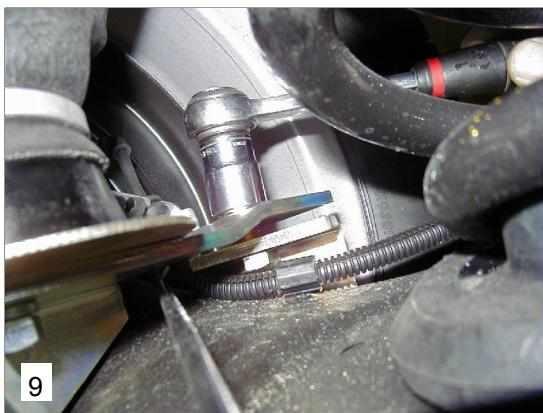
**NL** Draai de moer van de onderbeugel vast met **40 NM**
