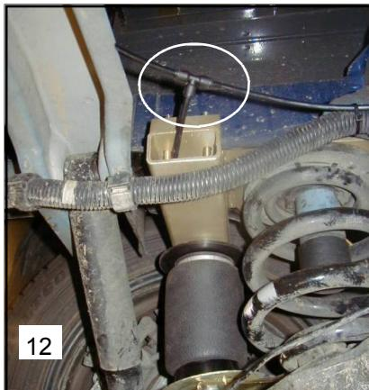
**NL** Leidt de luchtleiding naar het midden van de auto en monteer hier het T-stuk. Plaats het overgebleven stuk leiding in het T-stuk en leidt deze naar een geschikte plaats voor het vulventiel en de minimum drucksensor. Monteer deze volgens de bijgeleverde handleiding.
