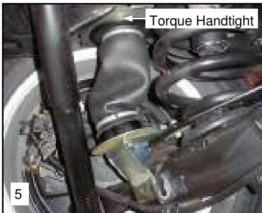
**NL** Verwijder de rubberen stop uit de voorzijde van de draagarm en haal de handremkabel uit de steun. Plaats de onderbeugel om de draagarm en laat de ovale steuntjes in de gaten van de draagarm centreren.
