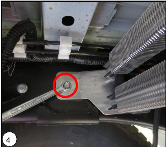
**NL** Links: Draai de bout van de brandstofkoeler steun los. Plaats bij voertuigen zonder brandstofkoeler net als aan de rechterzijde een M10 draadbus.
